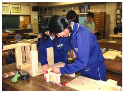
図2-6 電動ドリルによるコーススレッド接合と生徒相互の協力
