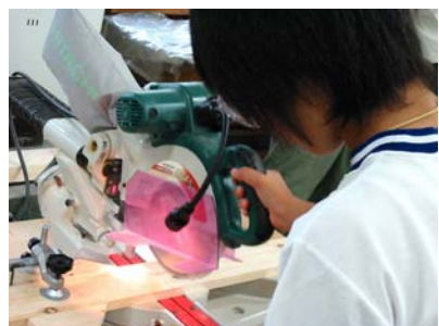
図2-3 卓上スライド丸のこによる切断と治具の工夫
