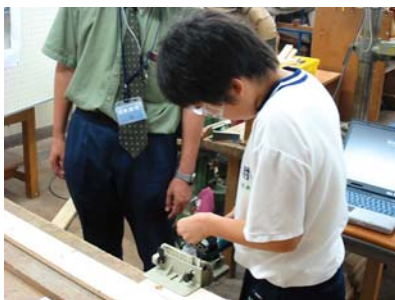
図2-5 ジョイントカッタによる溝加工と補助教員の援助
